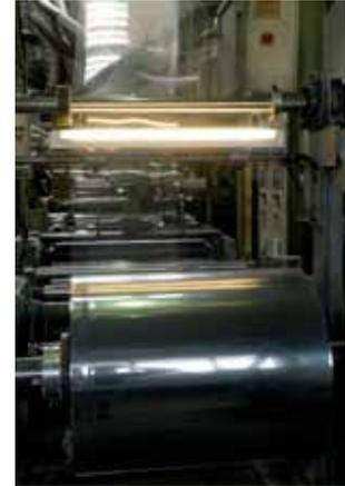
Erst jetzt kann das Material flüssig gemacht, durch eine Breitschlitzdüse auf eine hochglänzende Walze aufgetragen, gekühlt, schliesslich als Folie abgezogen und auf mächtige Rollen zur Weiterverarbeitung aufgewickelt werden.
