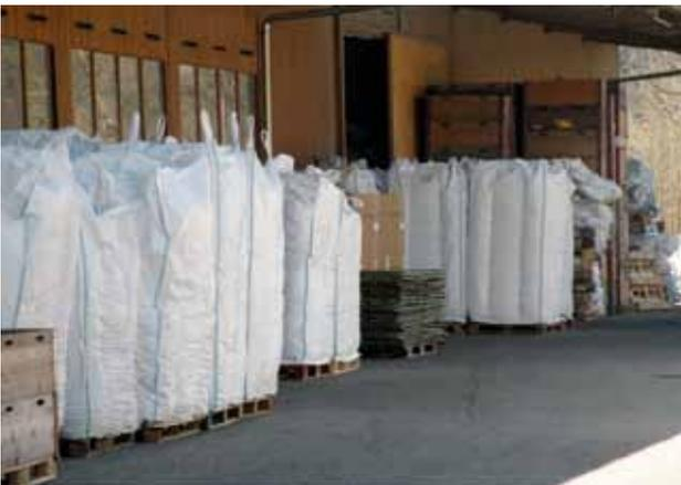
In mächtigen Säcken lagern sogenannte Flakes, das Rohmaterial aus geschredderten PET-Flaschen, vor dem Fabrikgebäude. Die Firma bezieht dieses Material von auswärts, da zum einen das sorgfältige Reinigen und Sortieren der gesammelten PET-Flaschen sehr aufwändig, zu teuer, und zum anderen mit viel Lärm verbunden ist.
